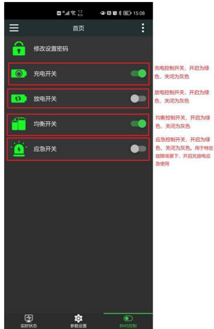
Figure 23 BMS control page 图 23 BMS 控制页
